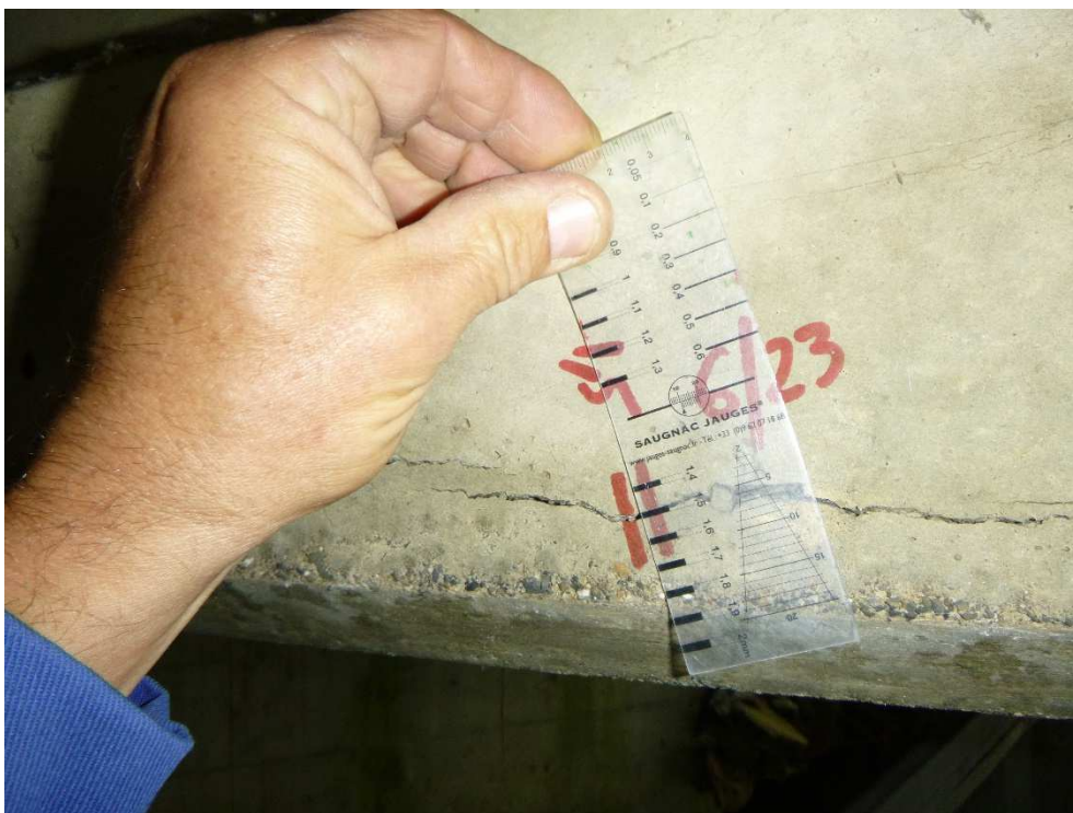
Figure 36 : pt3 – semelle inférieure ouverture de fissure de 1.5mm – coté RD aval
